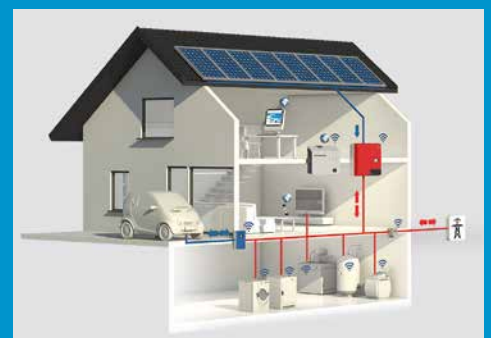
Photovoltaikanlage mit Energiespeicher und E-Mobil
