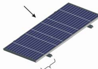
Schema: Unterstützungsabstände der Modulrahmen bei Auflage auf Querträger
