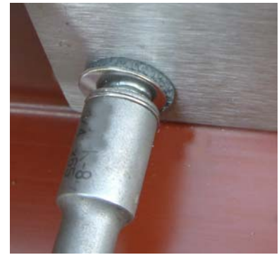
Beim Verschrauben auf leichte Pressung der Dichtung achten – bei größeren Stückzahlen mit Tiefenanschlag arbeiten!
